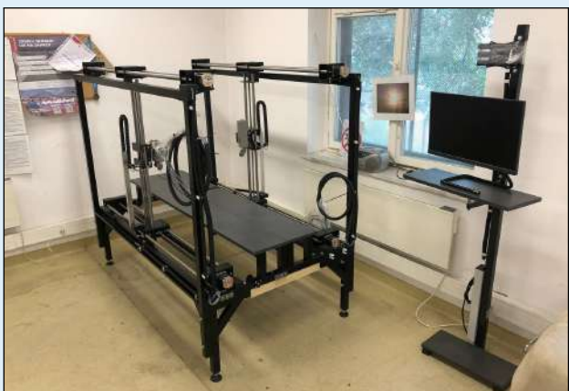
Frezarka EPS/XPS/EPP CNC hot wire Cut 1620S produkcji cnc-multitool Sales GmbHCo.KG
