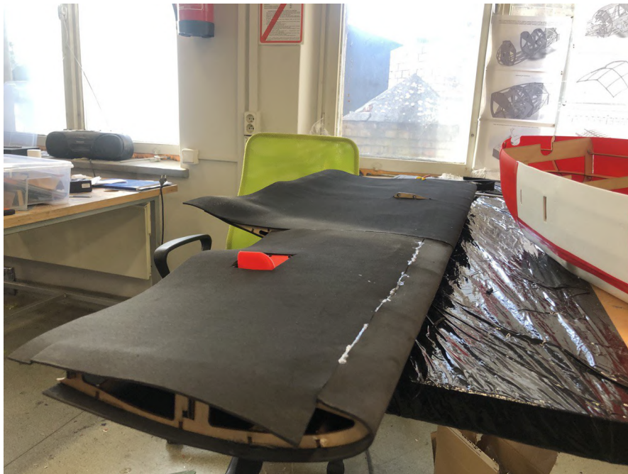
RYSUNEK 6.7: Skrzydło pokryte pianką EVA
