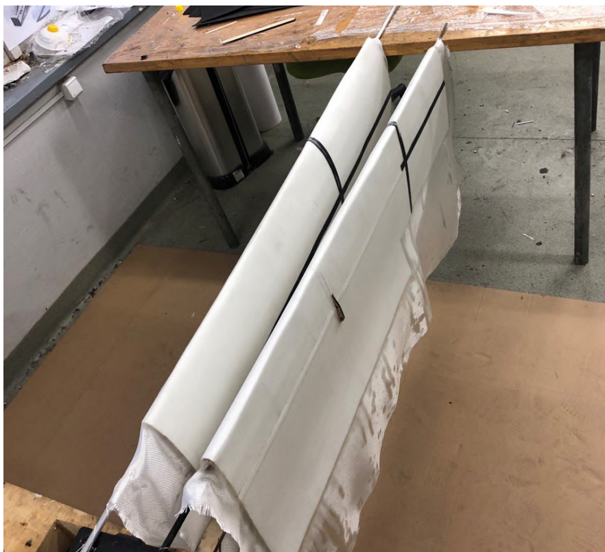
RYSUNEK 6.9: Skrzydło pokryte laminatem szklanym
