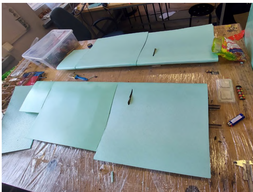
RYSUNEK 6.12: Skrzydło pokryte arkuszem polistyrenowym
