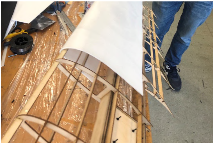
RYSUNEK 6.8: Skrzydło konstrukcyjne kryte depronem
