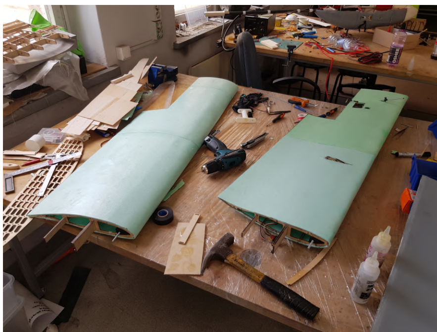
RYSUNEK 6.13: Skrzydło pokryte laminatem szklanym
