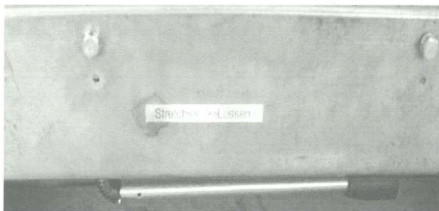
Dźwignia zwalniania naprężenia pasa
