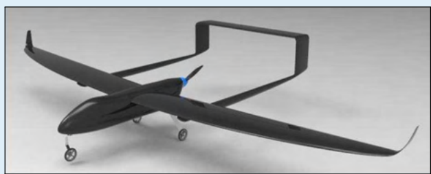
Pierwotny układ usterzenia ogonowego
