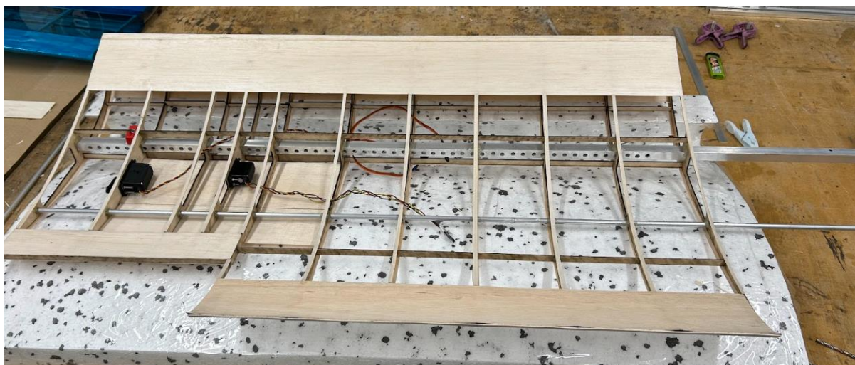
Zdj. 1. Fragment skrzydła w trakcie konstruowania
