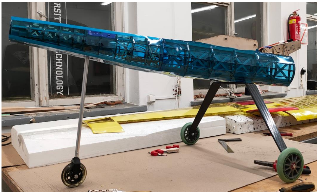
Zdj. 2. Podwozie przymocowane do kadłuba
